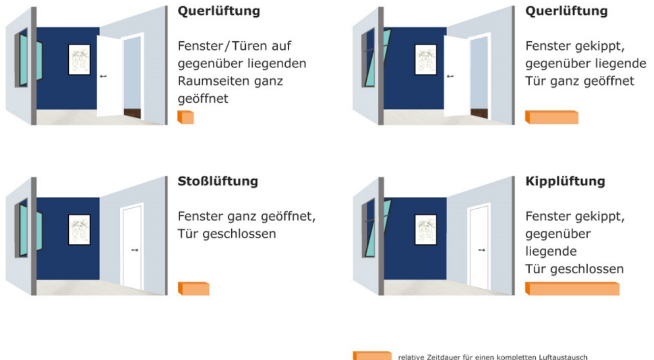
Abbildung 1: Lüftungsarten im Vergleich (Quelle: Energie Agentur NRW)
